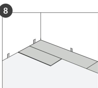
Das übrig gebliebene Stück winkeln Sie flach mit der Feder so weit wie möglich in die Längsseite der vorherigen Produktreihe ein und drücken es langsam herunter, sodass es spürbar einrastet.
