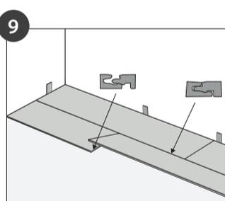
Längsverbindung: Das nächste vollständige Produkt wird wie zuvor erst längsseitig in einem Winkel von ca. 25° eingeschwenkt und noch vor dem Einrasten strinseitig dicht an das vorherige Produkt geschoben. Drücken Sie es langsam herunter, sodass die Längsseite spürbar einrastet.
