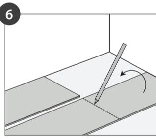
Markieren Sie das letzte Produkt der Reihe und markieren Sie dieses auf der Rückseite. Schneiden Sie es nun so zu, dass die erste Reihe gelegt ist. Das übrig gebliebene Stück wird den Anfang der zweiten Reihe bilden.
