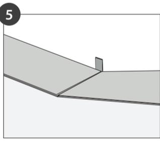
Die Produkte der ersten Reihe werden zuerst auf der kurzen Stirnseite verbunden. Es wird in einem Winkel von 25° angesetzt und eingeschwenkt. Achten Sie darauf, dass diese auf der Stirnseite exakt gerade ausgerichtet sind.
