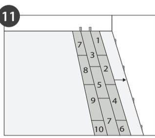
Verlegen Sie das Produkt im Raum gemäß der Nummerierung in der Abbildung. Die erste Reihe ist bei Bedarf anzuschneiden. Im Anschluss schieben Sie die vorinstallierten Reihen an die Wand. Der Abstand wird durch die Abstandskeile fixiert. Danach kann die Verlegung Reihe für Reihe fortgeführt werden.
