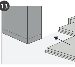
Müssen Sie einen Ausschnitt für eine Holztürzarge vornehmen, dann legen sie das Produkt gegen die Türzarge und kürzen dieses entsprechend der Höhe des Produktes. Achten Sie auch dort auf ausreichendes Bewegungsfugen von ca. 12 mm.
