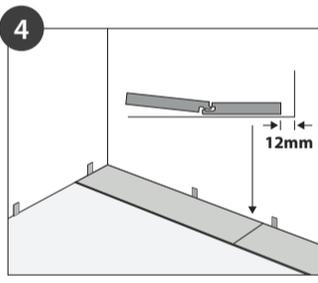
Entfernen Sie bei der ersten Produktreihe die Feder zur Wand. Lassen Sie zur Wand einen Abstand von ca. 12 mm.
