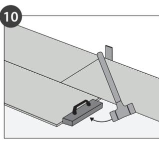
Querverbindung: Legen Sie nun den Schlagklotz auf das Profil und treiben es durch moderates Schlagen in die Nut-Feder-Verbindung der Stirnseite. Dieses Vorgehen kann für den gesamten Raum fortgeführt werden.
