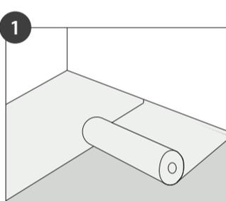
Verlegen Sie zum Schutz gegenüber aufsteigender Feuchte eine Aquastop Folie (Polyethylen-Folie). Die Folie sollte an den Wänden ca. 2 cm hochgezogen werden und an den Stoßfugen ca. 2cm überlappt und verklebt werden. Enthält ihre Dämmunterlage bereits eine Aquastop Folie, ist dieser Schritt zu übergehen.
