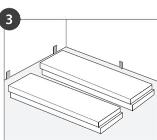
Bereiten Sie mindestens vier Pakete vor und wechseln bei der Verlegung zwischen diesen. Hierdurch wird ein ideales Verlegebild erzeugt.
