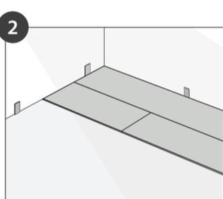
Die empfohlene Verlegerichtung ist längs zur Hauptlichtquelle. Die größtmögliche zusammenhängende Verlegefläche beträgt 8 m in Richtung Breite und 8 m in Längsrichtung. Zu Wänden, größeren Flächen und Räumen müssen passende Bewegungsfugen berücksichtigt werden.
